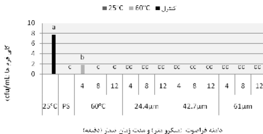
شکل 2- شمارش باکتری‌های کلی فرم آب آلبالو تحت تاثیر تیمارهای دمایی، زمان و دامنه فراصوت (حروف غیر مشابه نشان دهنده اختلافات معنی دار در سطح احتمال 5 درصد است)
