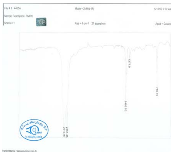
شکل ۲- تصویر نمودار طیف IR از نمونه‌ی پلی اتیلنی
